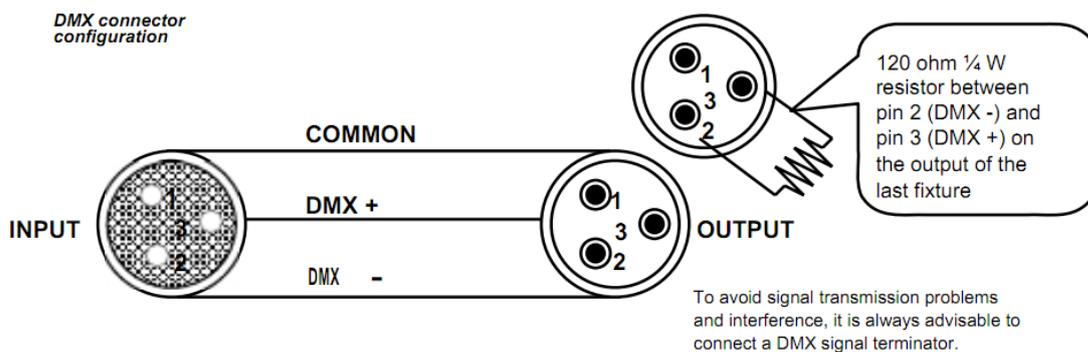
\* 120 ohm ¼ W entre o resistor do Pino 2 (DMX -) e o Pino 3 (DMX +) na saída do último aparelho
