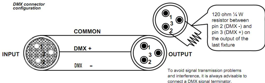
\* 120 ohm 1/4 W entre o resistor do Pino 2 (DMX -) e o Pino 3 (DMX +) na saída do último aparelho
